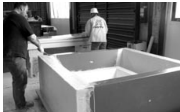
de eerste stap in het handmatige productieproces met polyesterhars
