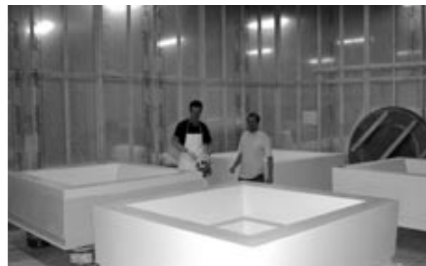
de witte coating minimaliseert kleurverschillen bij beschadiging en verschaft een lichte glans
